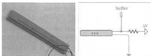
그림 2 ON/OFF 스위치 센서의 외형과 회로도
