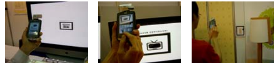
그림 2. 증강 현실 컨트롤러를 이용한 스마트 오브젝트 제어
