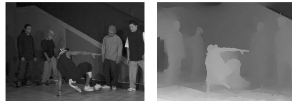
〈그림 7〉 원영상(좌)과 스테레오 정합 알고리즘을 통해 얻은 변이맵(우)
