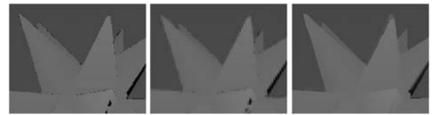
(a) 원본 (b) 쌍입방 보간법 (c) 제안한 방법 그림 4. 확장된 깊이 지도의 부분 확대 영상
