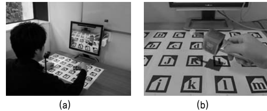
그림 5. 실험 환경: (a) 사용자는 디스플레이 장치를 통해 증강 장면을 볼 수 있음; (b) 사용자의 앞에는 기준 좌표계가 되는 트래킹 패턴 보드가 놓여 있음. 사용자는 조작 도구를 손에 쥐고 있음.
