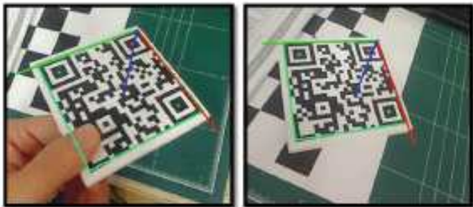
그림 6. QR코드 검출 및 자세 추정
