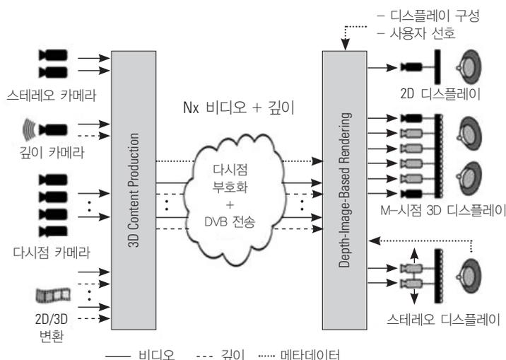
[그림 2] FTV/3DV 표준 시스템 모델
