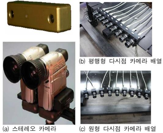
그림 4. 수동형 방식을 위한 영상 획득 시스템
