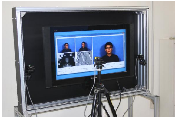
그림 8. 시선 맞춤을 위한 스테레오 카메라 시스템
