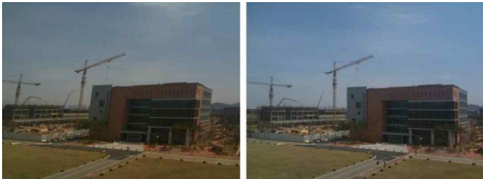
그림 1 Rolling Shutter로 인해 왜곡된 영상과 원본 영상
