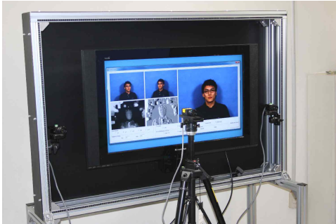
그림 8. 시선 맞춤을 위한 스테레오 카메라 시스템 Fig. 8. Stereo camera system for eye gaze correction
