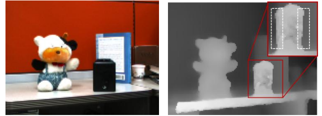
(a) 컬러 영상 (b) 획득한 깊이 영상 그림 3. 깊이 영상의 경계 오류
