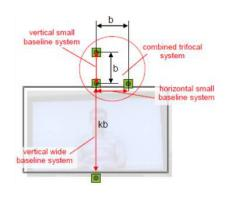
〈그림 7〉 HHI 시선 맞춤 시스템
