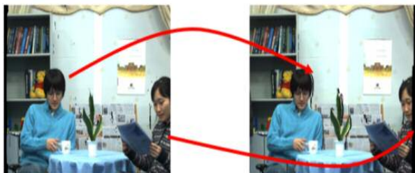
그림 5. 워핑 결과 영상을 통한 홀 채움 과정
