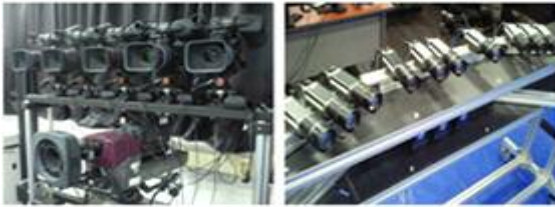
그림 2. 멀티뷰 카메라 시스템
