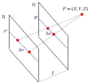
Fig. 3 Two-plane parameterization
