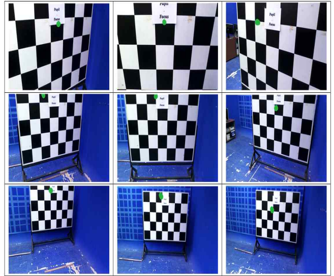
(그림 4) 목표물 거리에 따른 초점 위치 측정 결과
